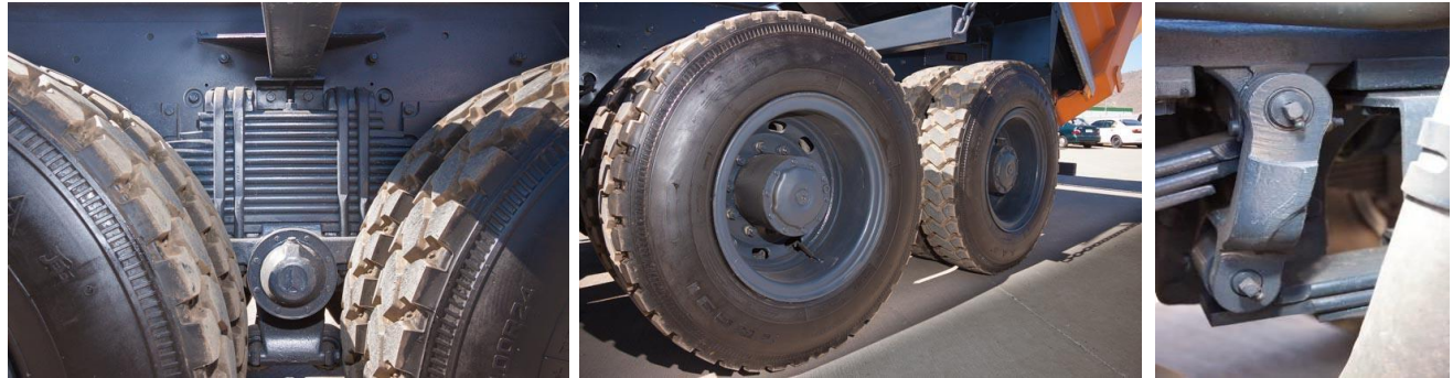
Suspensión Mercedes-Benz Faenera de doble abrazadera, adelante con bujes de bronce
